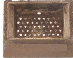
Brasero que necesita una limpieza, con los orificios obstruidos por la ceniza
