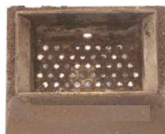
Braseiro que precisa de limpeza com os orifícios tapados por cinzas
