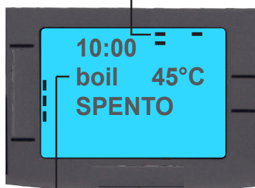
Visualizza temperatura Boiler
