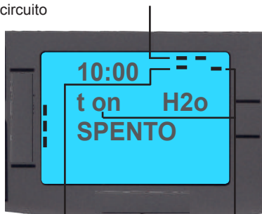
Termostato esterno attivo ton - richiesta - toff - no richiesta
