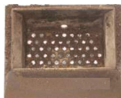
Brasero que necesita una limpieza, con los orificios obstruidos por la ceniza
