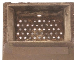
Braciere che necessita di pulizia con i fori otturati dalla cenere
