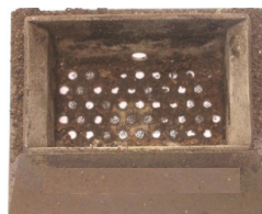
Brasero nécessitant d'être nettoyé avec les trous bouchés par les cendres
